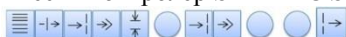
Фиг. 2. Символна схема на манипулациите при производството на ротационен детайл „шапка“: магазин; отделяне; подаване; позициониране (затягане); обработване (на бусула); подаване (на детайла); позициониране; обработване (струговане), обработване (отрязване); изнасяне, съгласно Dimitrova R. & G. Hadzhikosev (2013).
