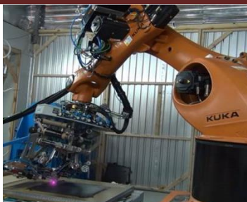
Слика 2: Машина за автоматско полагање на термопластичен препрег
