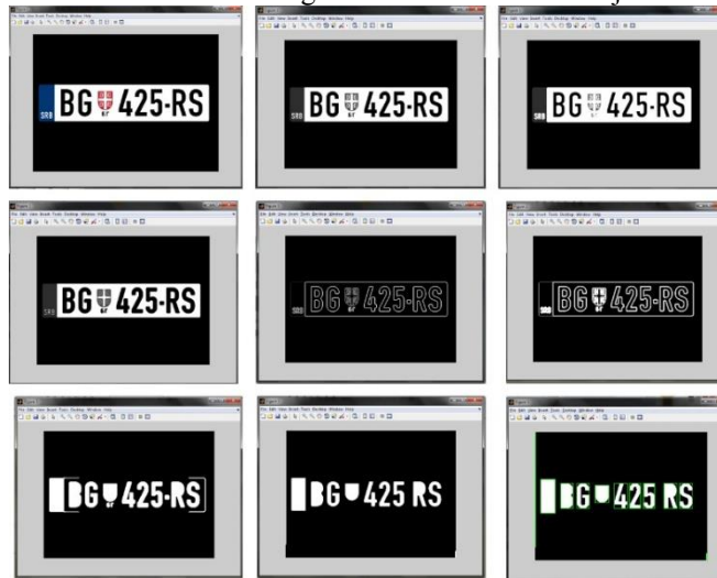
Slika 8. Kompletan prikaz obrade slike korišćenjem opisanih procesa u Matlabu
