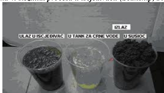
Slika 4. Rezultat procesa u iscjeđivaču (Scanship, 2006.)
