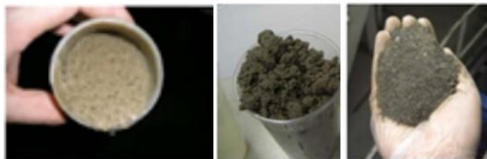
Slika 6. Prikaz obrađene bio-mase (taloga) - a) talog prije cijedenja b) talog prije sušenja c) osušena bio-masa (Scanship, 2006.)
