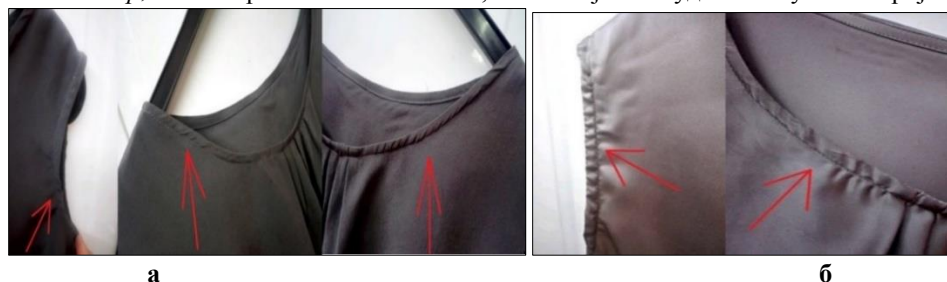
Слика 5. Дефект – брчкање на шевот на ракавен и вратен отвор, ткаенина А (лево), ткаенина Б (десно)
