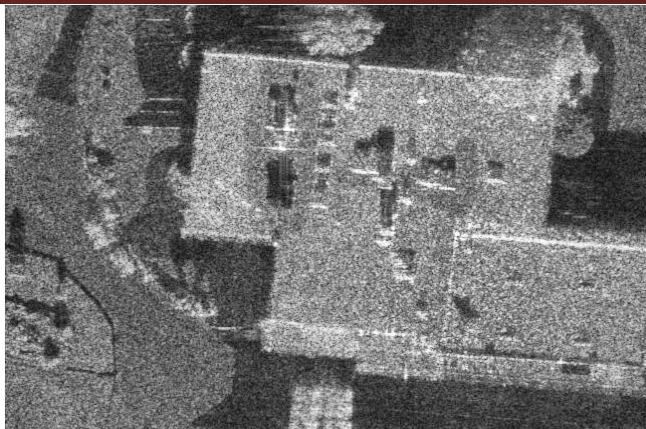
Фигура 4. Използване на гаусов филтър с размери 3x3 пиксела и \sigma = 0,5 .
