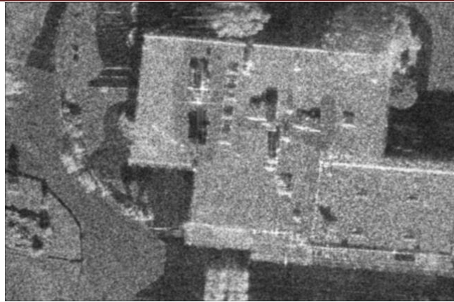
Фигура 10. Използване на гаусов филтър с размери 5x5 пиксела и \sigma = 1 .
