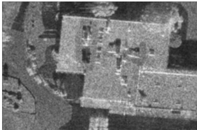
Фигура 8. Използване на осредняващ филтър с размери 3x3 пиксела.
