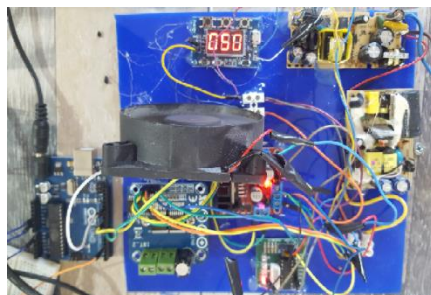
Слика 5. Прототип на контролно коло базирано на микроконтролер Амега 328P и мостен конвертор реализиран со BST7960 за генерирање на биполарен квадратен напон
